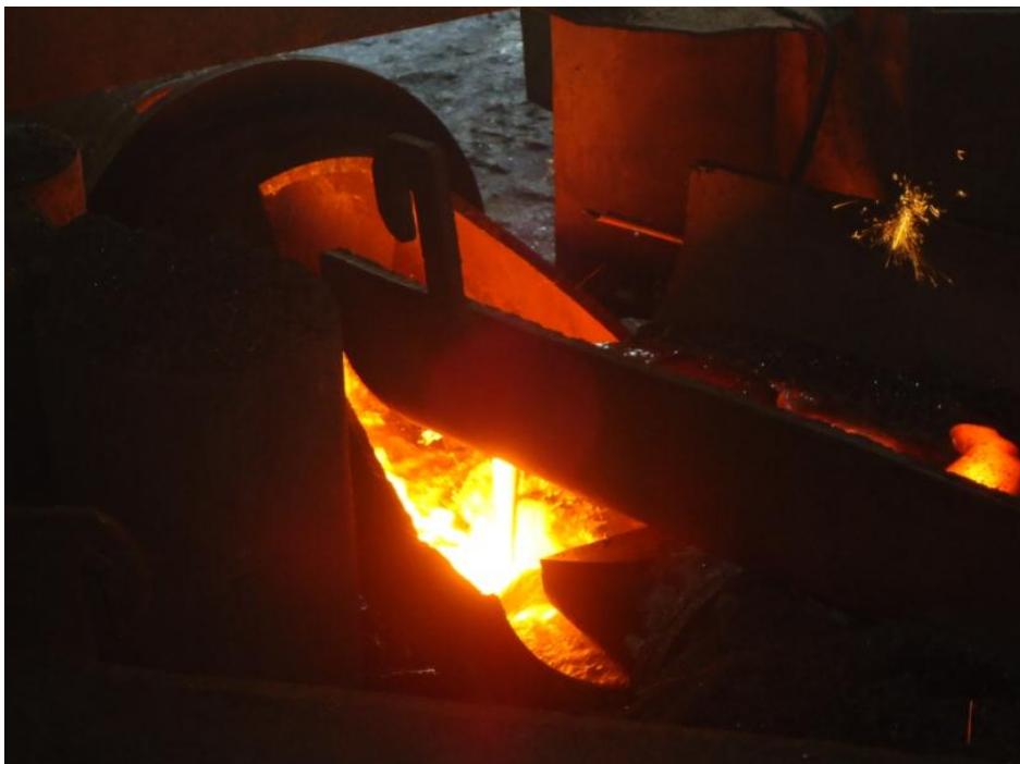
Figura 18: Escória líquida em contato com a água
