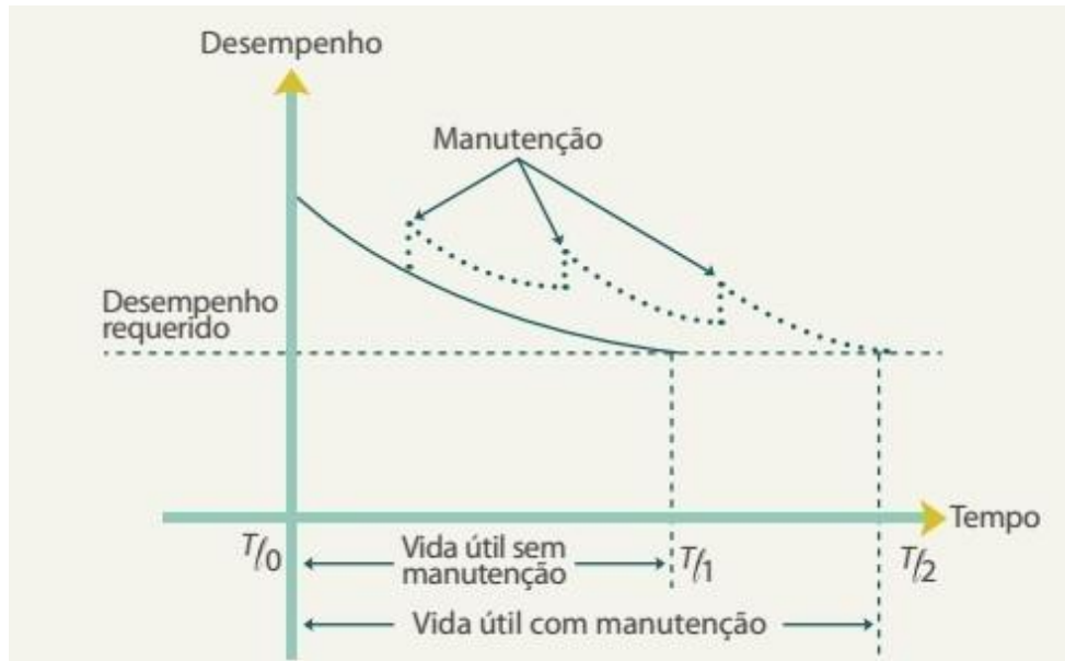
Figura1: Importância da manutenção para o desempenho da edificação Fonte: MARTINS – Câmara Brasileira de Indústria da Construção (CBIC), 2017
