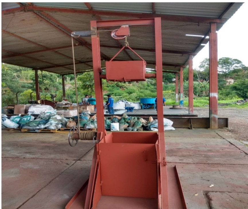
Figura 41 - Shatter Test utilizado para os testes.
