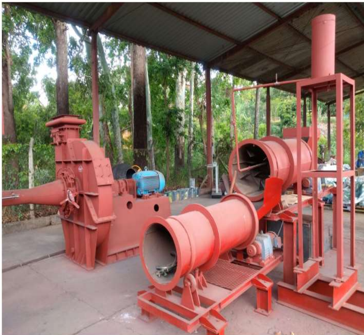
Figura 38 - Micropelotizador tipo tambor rotativo.
