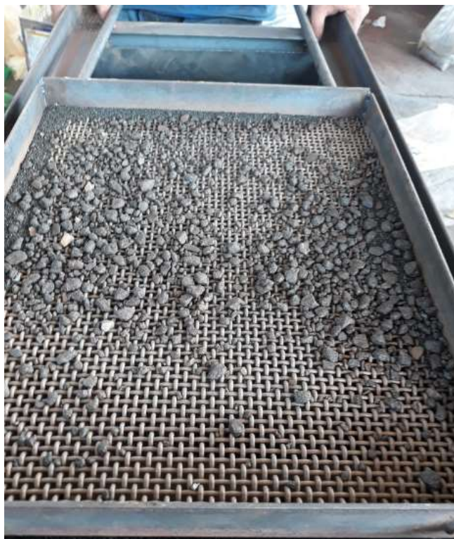
Figura 33 - Modelo de peneira usado no processo de peneiramento de material
