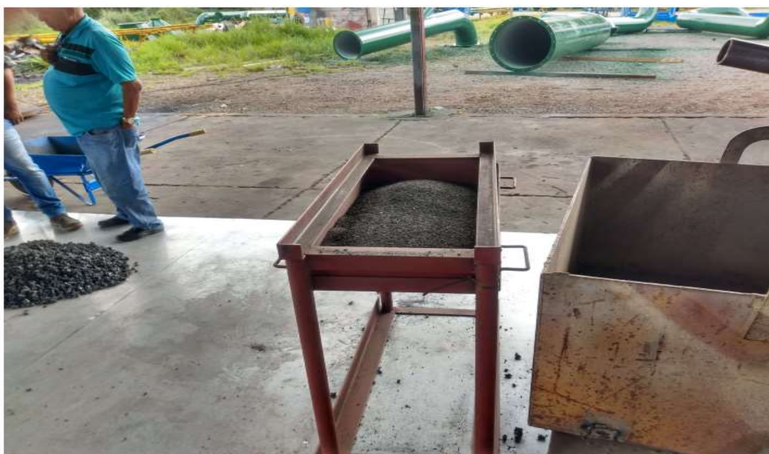
Figura 32 - Área de peneiramento de material
