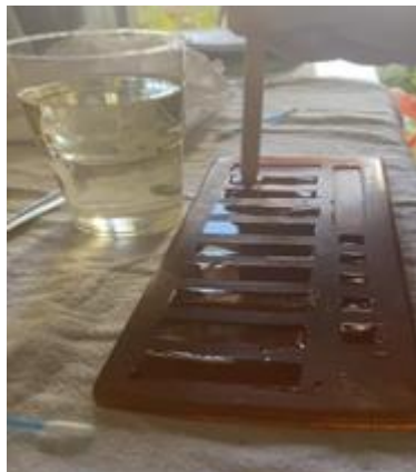
Figura 8: Processo de fabricação dos corpos de prova com moldes de silicone.
