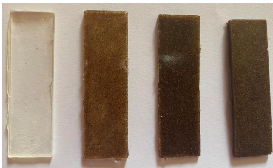
Figura 9: Corpos de provas apenas com resina com 5%, 10% e 20% de biomassa.
