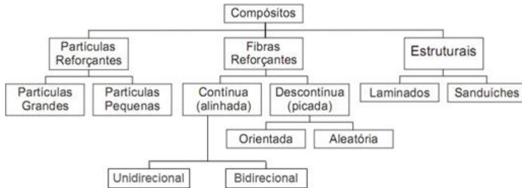
Figura 1: Esquema de classificação dos materiais compósitos.
