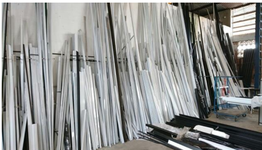
Figura 10: Armazenamento inadequado de sobra na produção
