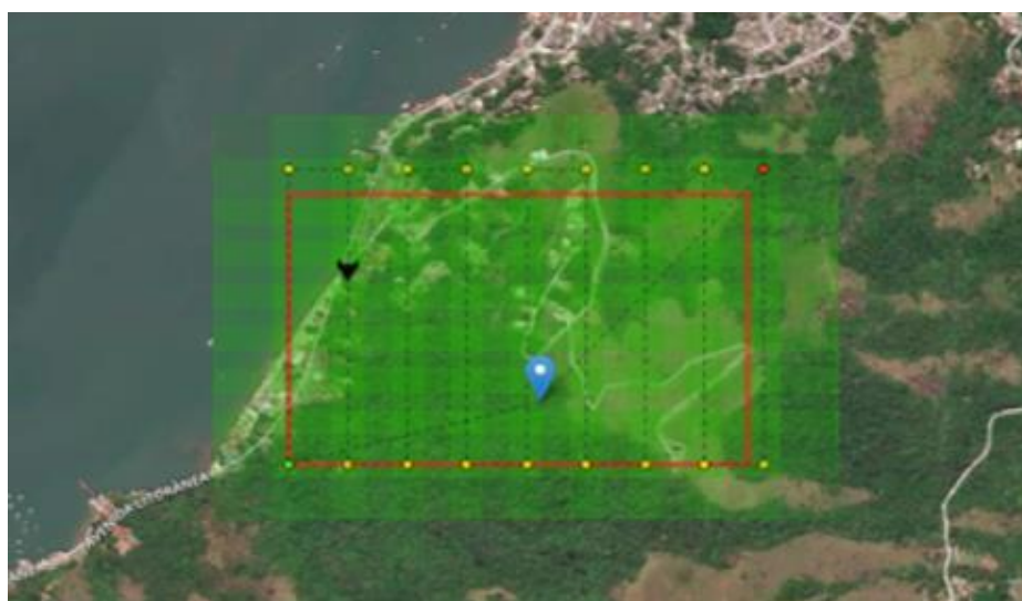
Figura 4 - Rota do VANT para realização da Aerofotogrametria.
