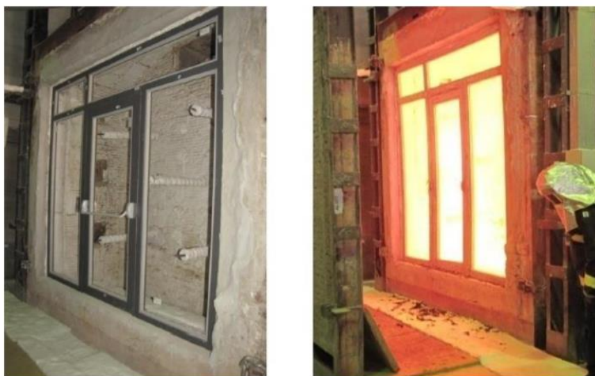
Figura 31 – Ensaio de resistência ao fogo em unidade envidraçada (Fonte: OLIVEIRA, 2016)
