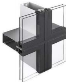
Figura 3 - Detalhe Genérico - Vidro e Alumínio (Fonte: Potiguara, 2017)
