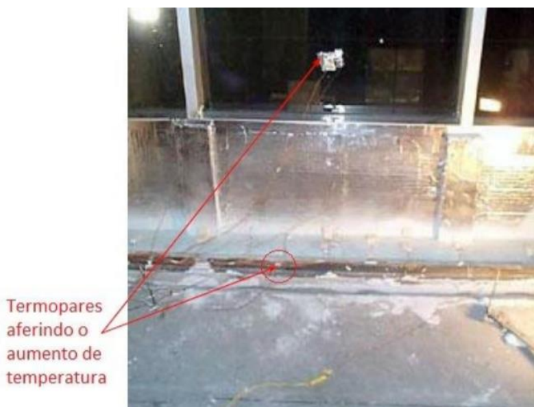
Figura 29 – Localização de alguns termopares antes do início do ensaio (Fonte: TOMA, 2012)
