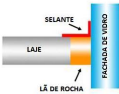
Figura 19 - Barreira periférica contra fogo. (Fonte: TOMA, 2012)
