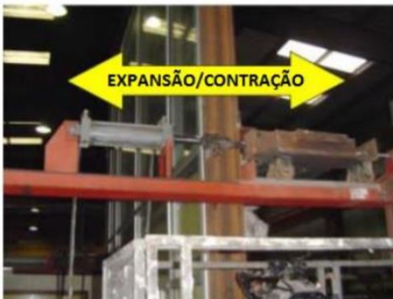
Figura 23 - Ensaio de movimento cíclico (Fonte: NICHOLAS, 2005)
