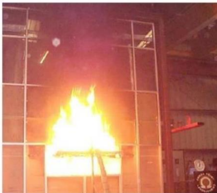
Figura 25 – Característica do incêndio gerado pelo queimador externo em uma fachada de teste com o montante de alumínio centralizado (Fonte: NICHOLAS, 2005)
