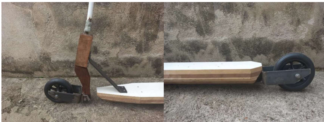
Figura 90 - Sistema de rodas dianteiro e traseiro
