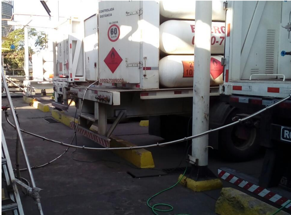
Figura 14 - Posicionamento da carreta na baía (carregamento de hidrogênio)
