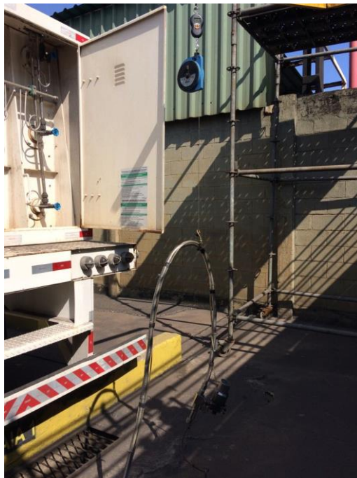
Figura 20 - Verificação do peso da mangueira de enchimento com uso de uma balança portátil
