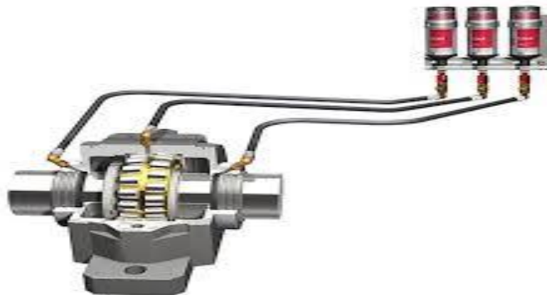
Figura 39: Lubrificação de rolamentos
