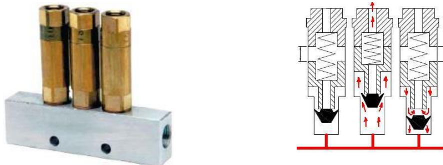
Figura 36: Distribuidor linha simples Fonte: Catálogo Distribuidor linha simples 320, LUBEQUIP EXIMPORT.
