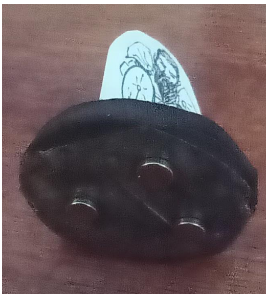
Figuras 109 – Ímãs de neodímio sob a base de EVA da peça simulada
