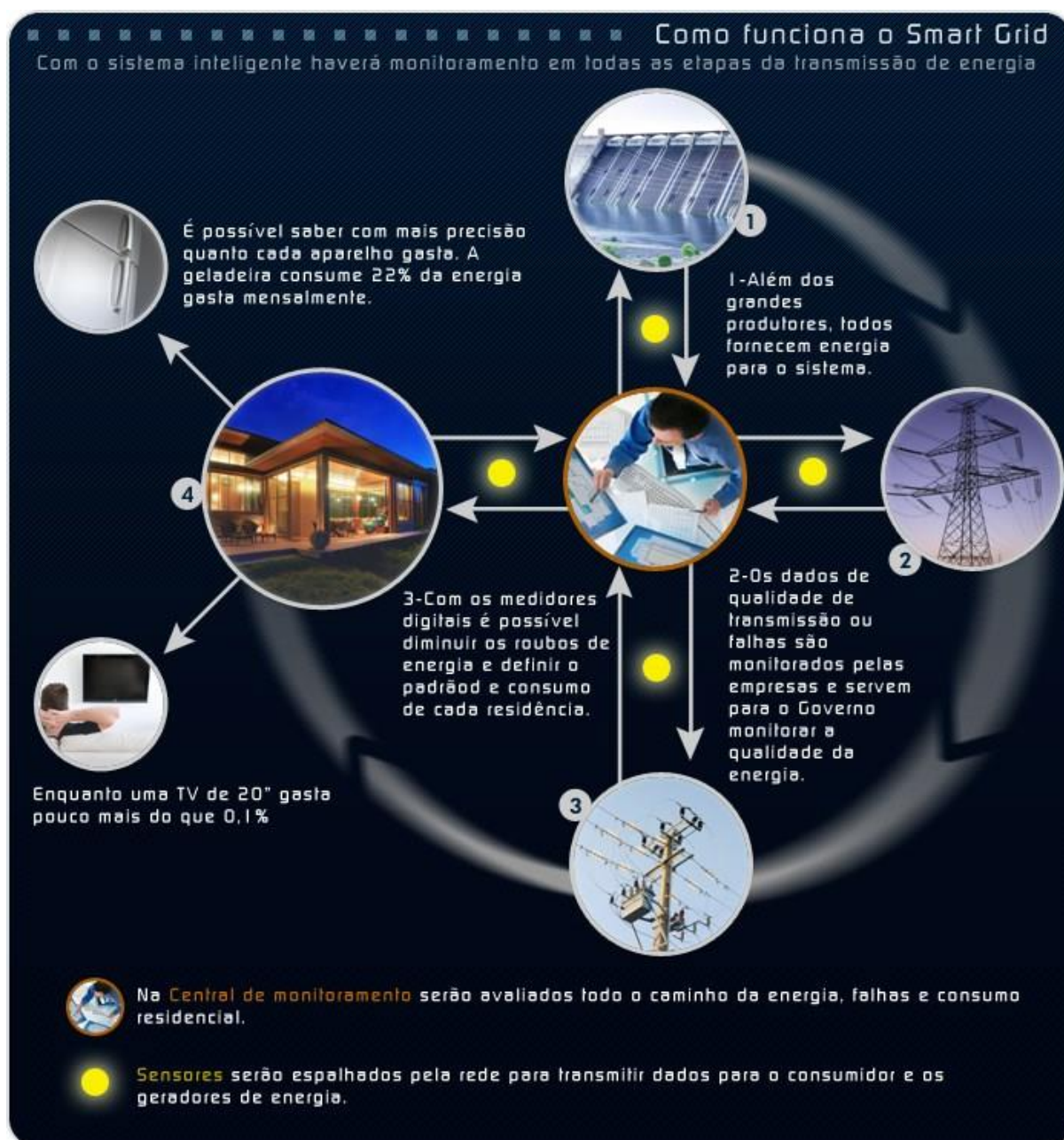
Figura 5 - Funcionamento do sistema Smart Grid.
