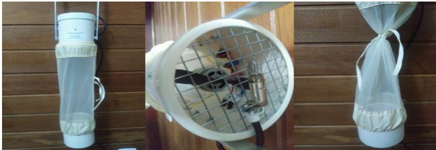
Figura I. Armadilha luminosa tipo CDC.
