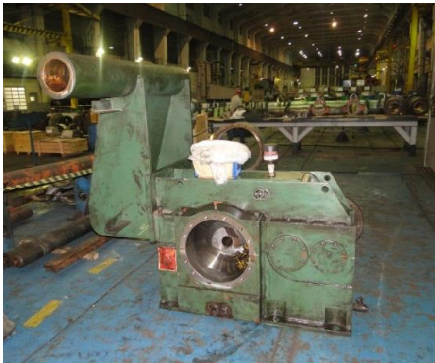
Figura 45. Caixa redutora da desbobinadora montada, ainda com o eixo quebrado Fonte: elaborado pelos autores.
