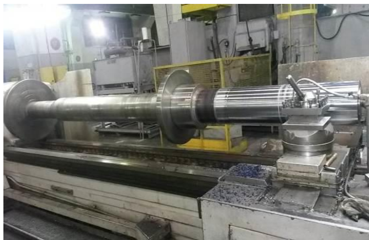
V Figura 52: Usinagem do eixo após soldagem Fonte: elaborado pelos autores.
