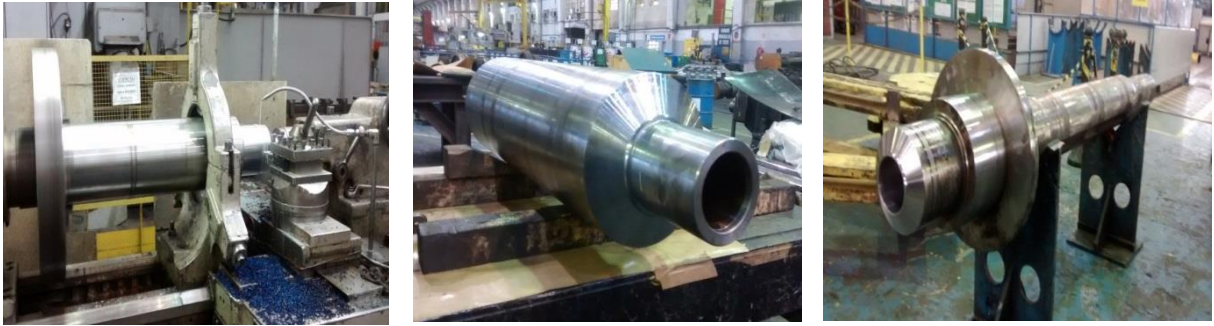
Figura 49: Usinagem da Ponta Postiça e do Eixo de Mandril Fonte: elaborado pelos autores.
