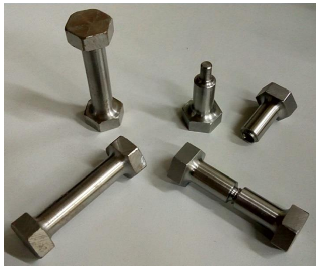
Figura 29: Fotografia dos dois modelos de corpo de prova utilizados no teste. Corpos maciços e corpos a serem emendados por soldagem Fonte: elaborado pelos autores.
