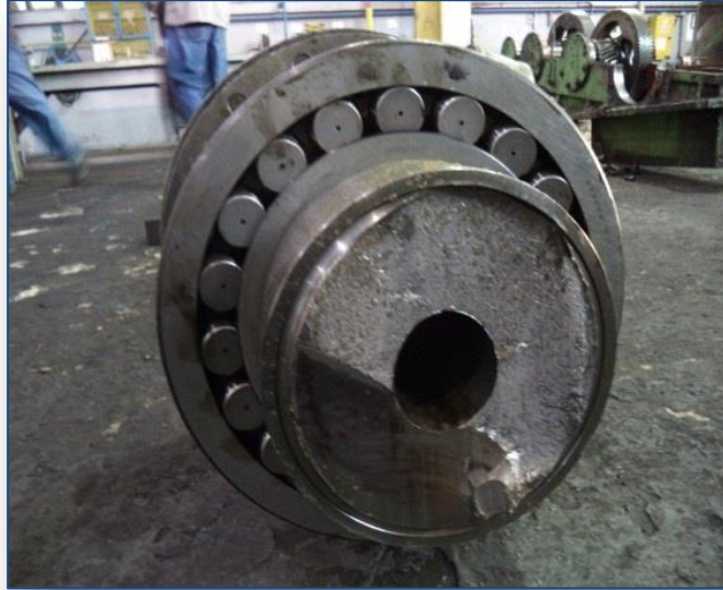
Figura 46. Detalhe da Fratura do Eixo de Mandril Fonte: elaborado pelos autores.
