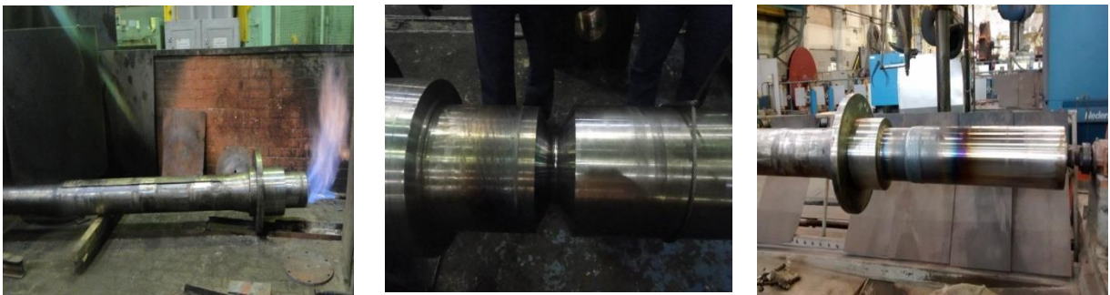
Figura 50: Montagem das partes a serem soldadas Fonte: elaborado pelos autores.
