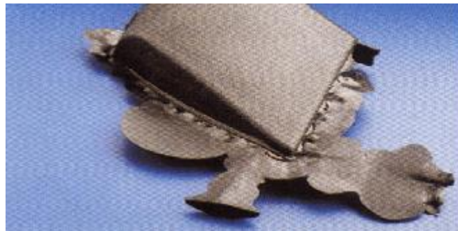
Figura 17: Exemplo de Defeito Tipo Rebarba
