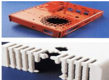
Figura 15: Exemplo de Defeito Tipo Peça Falhada
