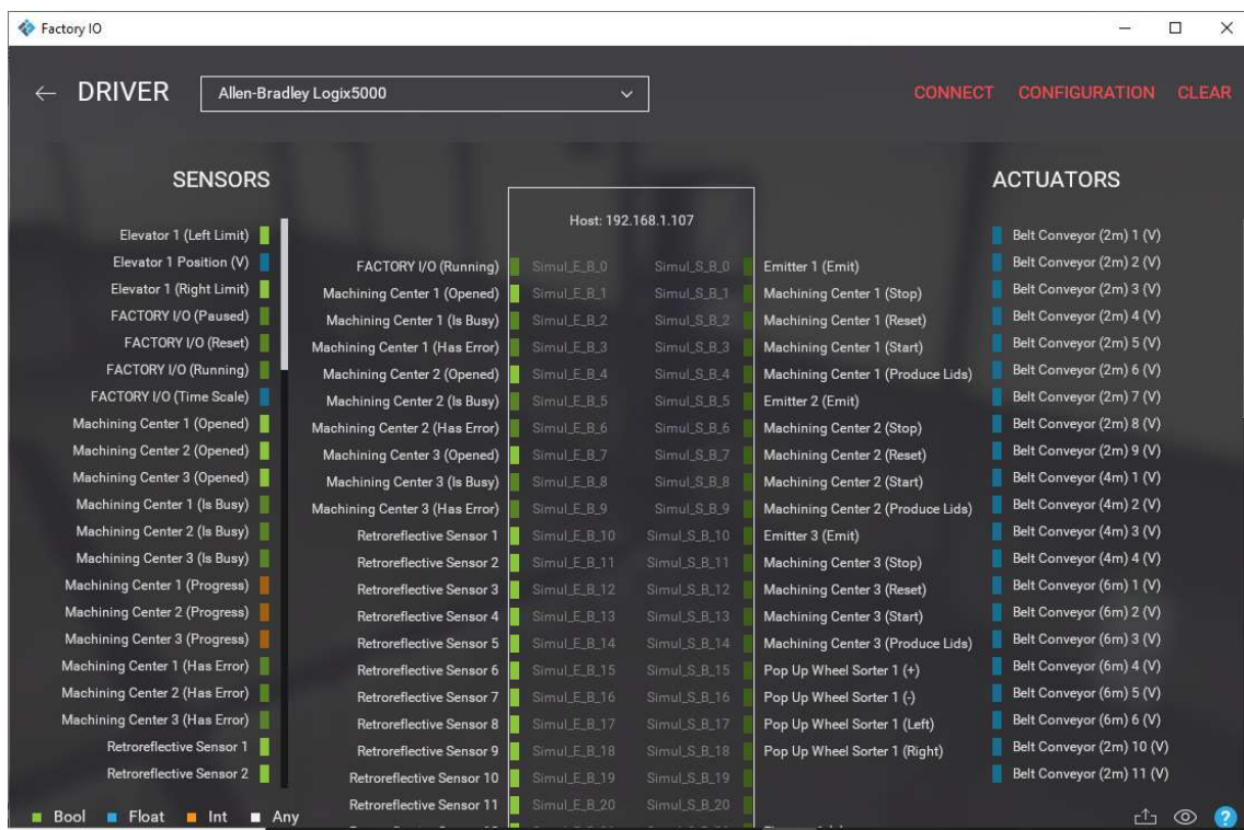
Figura 52: Alocação endereços de memória dos sensores e atuadores do emulador.
