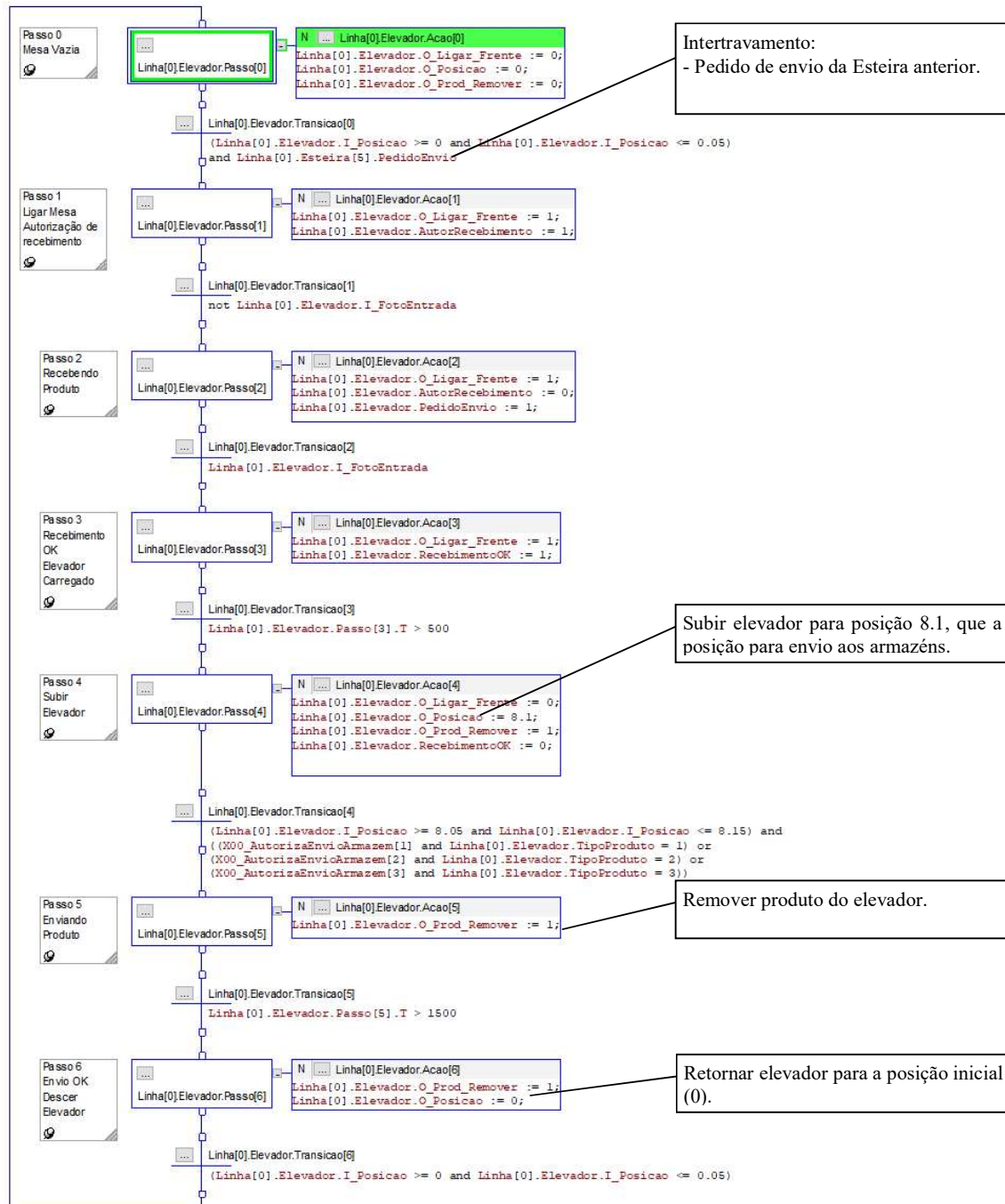
Figura 69: Programa de sequenciamento do elevador. Fonte: Programa de CLP TCC Carlos Borges (2020).
