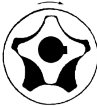
Figura 7 – Bomba de engrenagens internas tipo gerotor.
