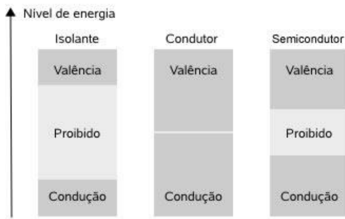
Figura 4 – Composição eletrônica dos condutores, isolantes e semicondutores Fonte: Mundo Educação UOL
