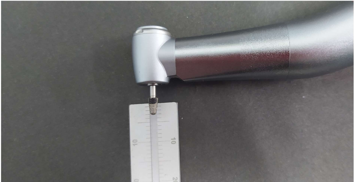
Figura 5. Marcação da broca para determinar a profundidade do preparo.
