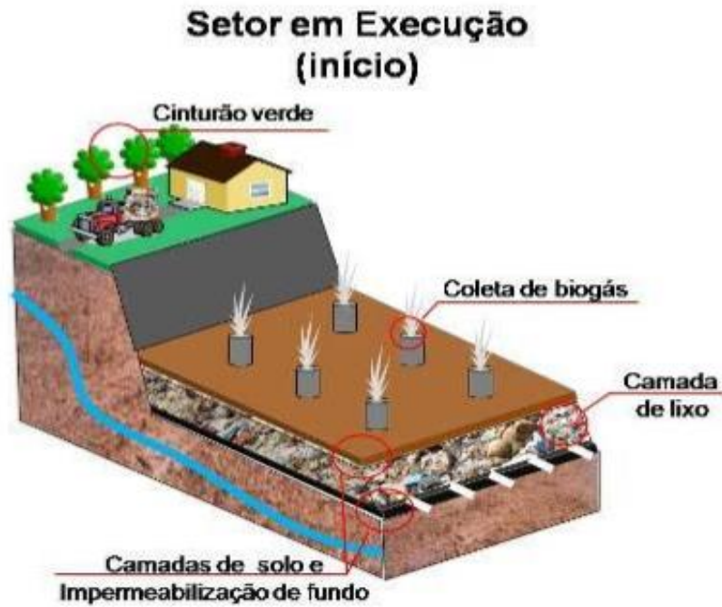
Figura 2 - Representação de um aterro sanitário – Setor em execução (Início)
