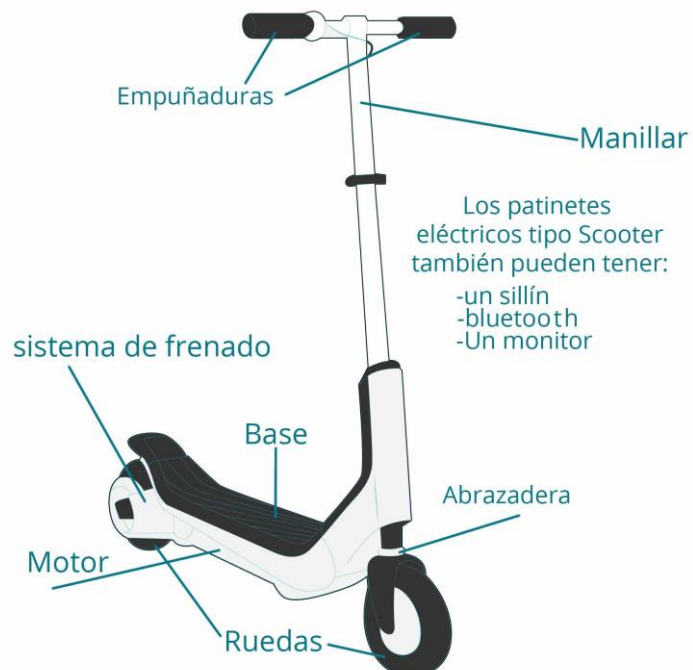
Figura 32: Partes de um Patinete Elétrico Fonte: itecnotoys, 2018
