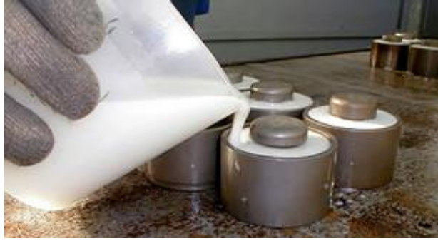
Figura 68: Processo de fabricação da roda por PU fundido
