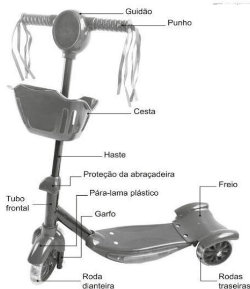
Figura 30: Partes de um patinete infantil não elétrico
