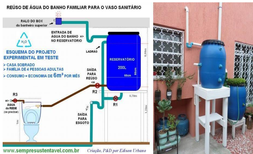
Figura 17. Sistema de reuso de água do banho familiar para vaso sanitário 1.
