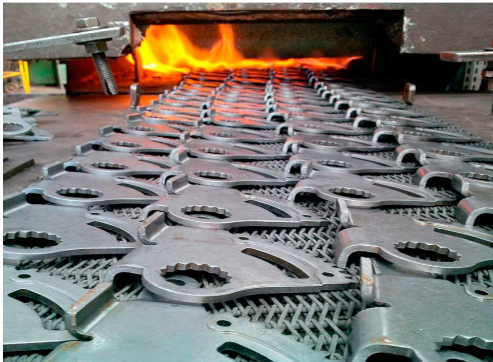
Figura 12- Revenimento em peças de aço
