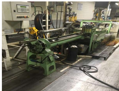
Figura 5 – Máquina de trefilação sem fieira – Registrada pelos autores
