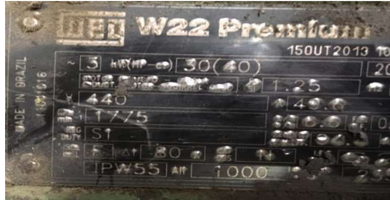
Figura 80 – Placa com informações do motor elétrico – Motor do subconjunto do projeto.
