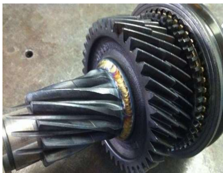
Figura 38 – Junta soldada – Site Chave Soldas
