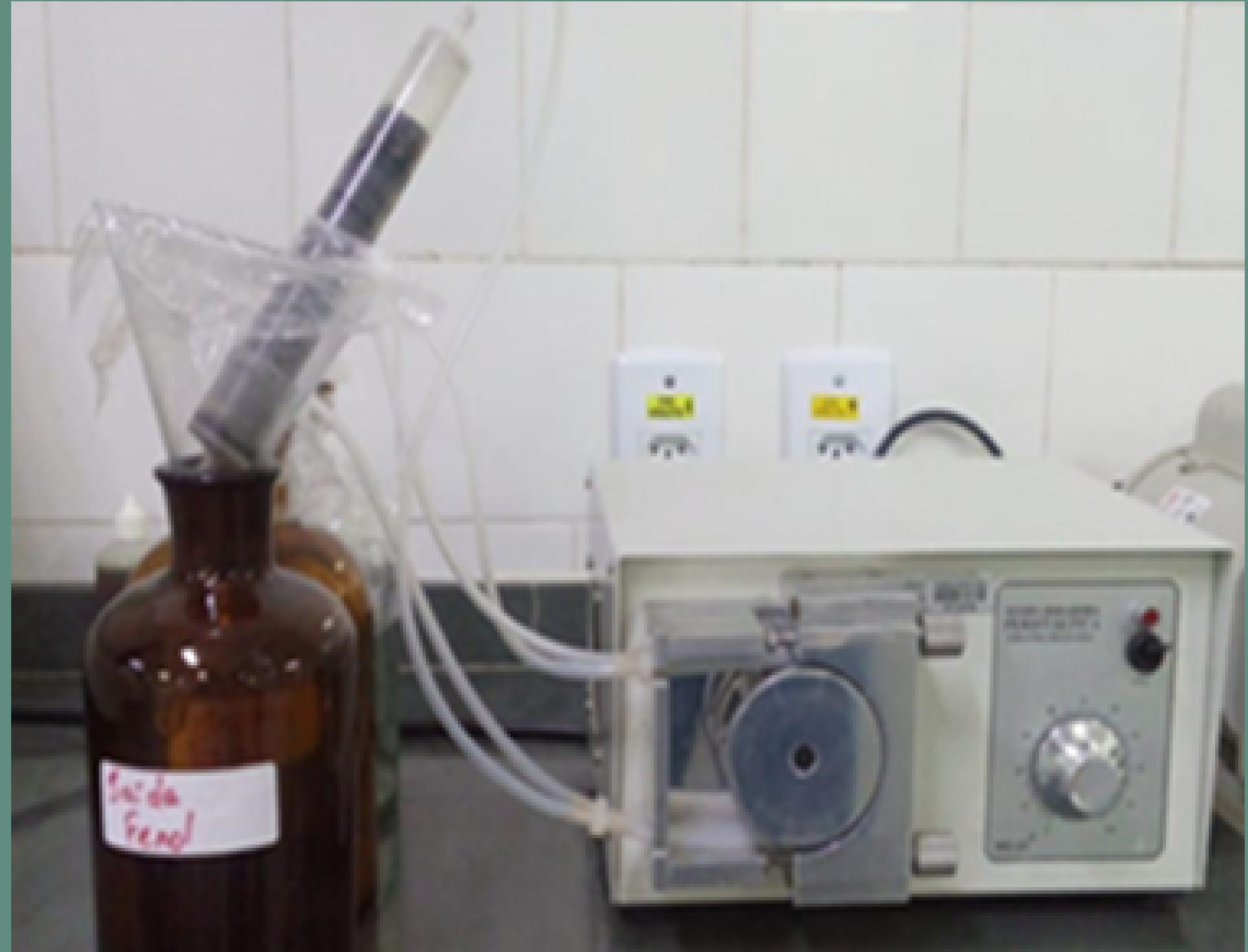
Figura 11b. Ensaio de adsorção do filtro à base de carvão com auxílio de bomba peristáltica Fonte: A Autora (2021)
