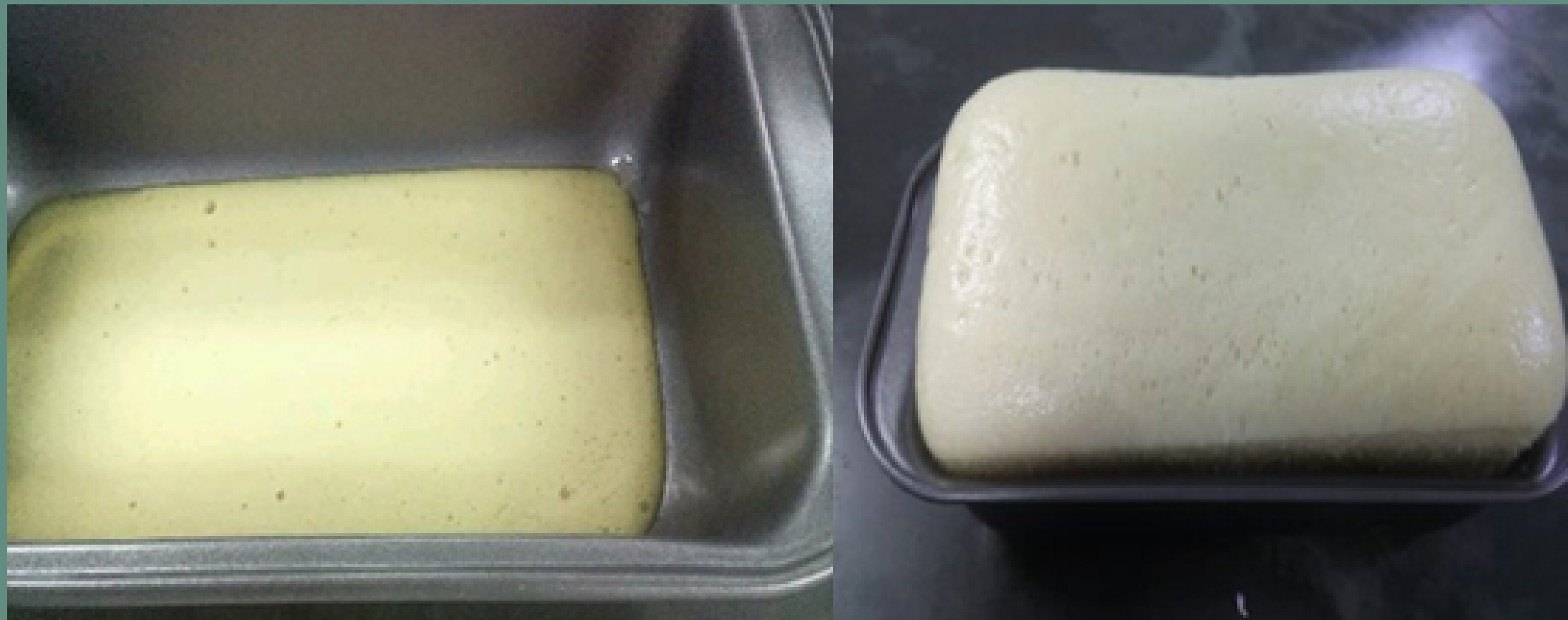
Figura 9. Reação entre o polioli e o isocianato formando a resina de poliuretano
