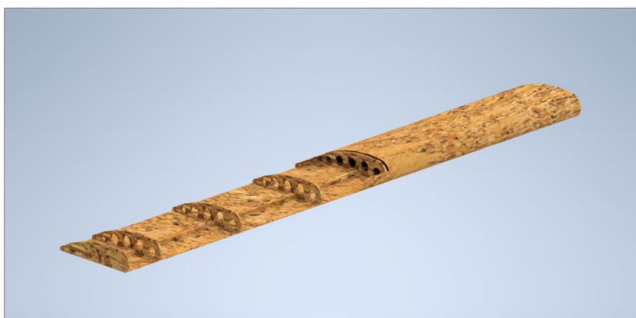
Figura 49. Asa modelada com representação realística com o material de compósito de fibra de bananeira.
