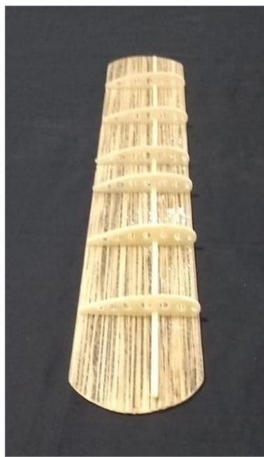
Figura 47. Estrutura interna da asa de compósito real.
