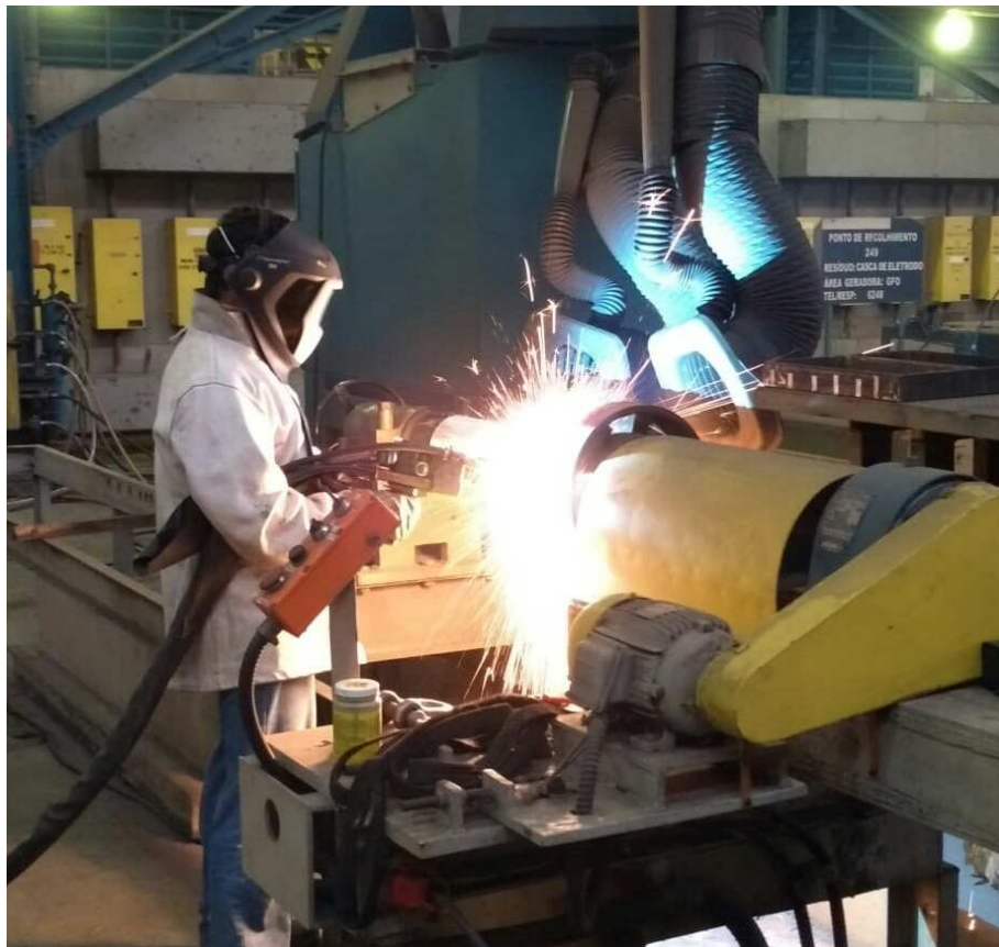
Figura 32: Jato de metal de asperção sendo direcionado sem precisão
