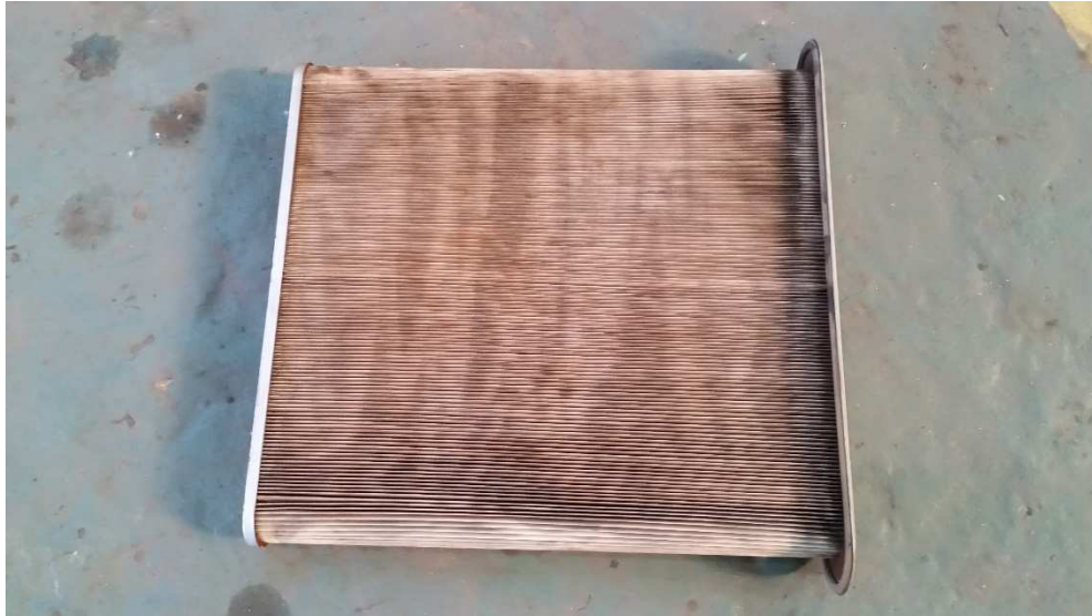
Figura 47: Filtro após limpeza
