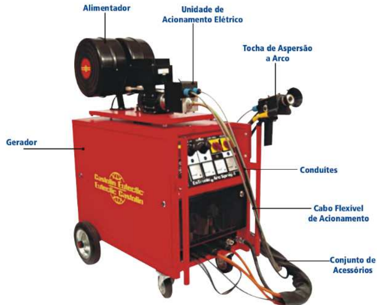
Figura 1: Componentes da máquina de aspersão térmica
