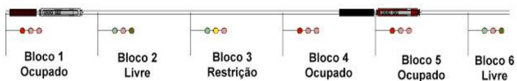
Figura 17 – Diagrama de sinalização Fonte: (BRANDI, 2007)
