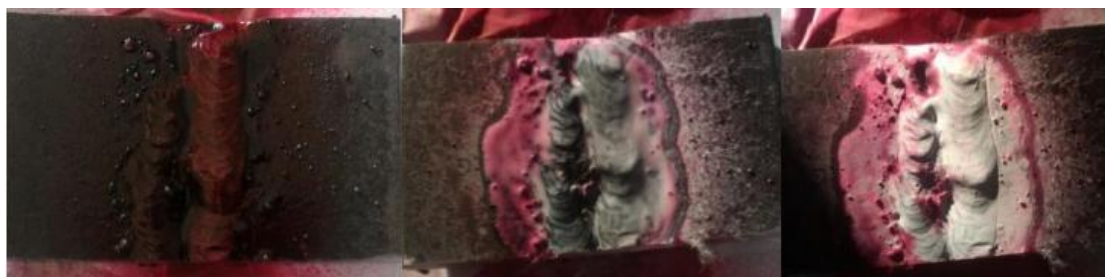
Figura 15 - As Tres Etapas do Ensaio por LP
