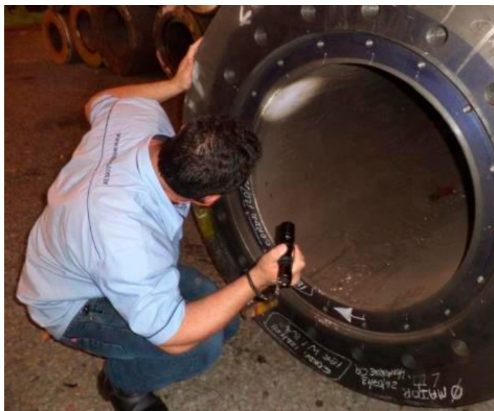
Figura 3 - Ensaio Visual de Solda com Iluminação Auxiliar
