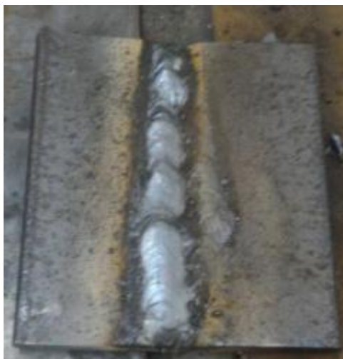
Figura 14 - Corpo de Prova com Cordão de Solda
