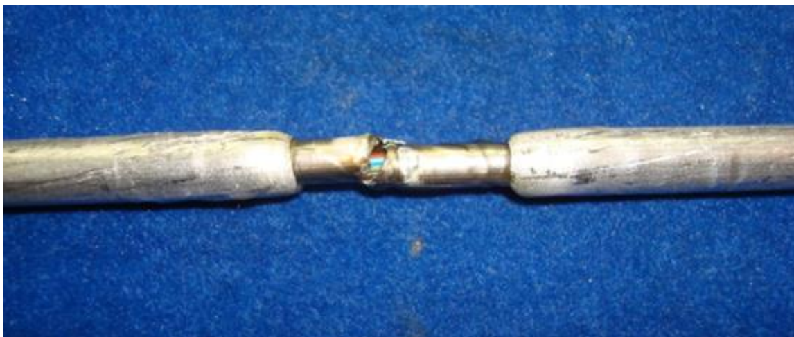
Figura 26 - Rompimento do tubo durante o quarto ensaio. Fonte: Autora (2018).
