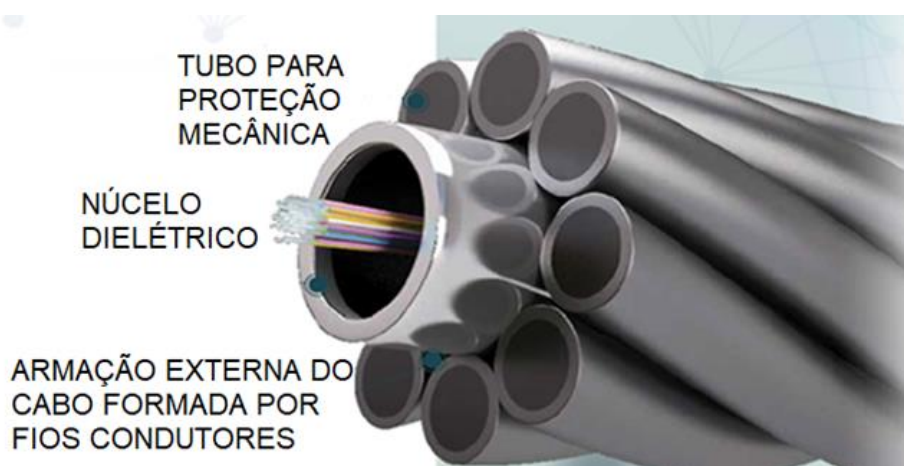
Figura 4 - Armação do cabo OPGW. Fonte: [14]
