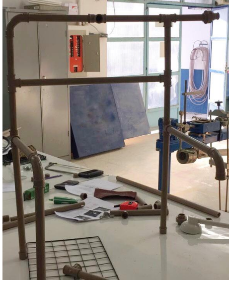
Figura 21: Construção da Primeira Parte do Equipamento de Inderbitzen Simplificado Fonte: Autora, 2018
