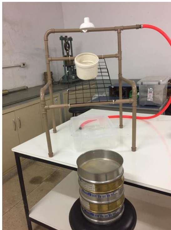
Figura 22: Parte Final do Equipamento de Inderbitzen Fonte: Autora, 2018
