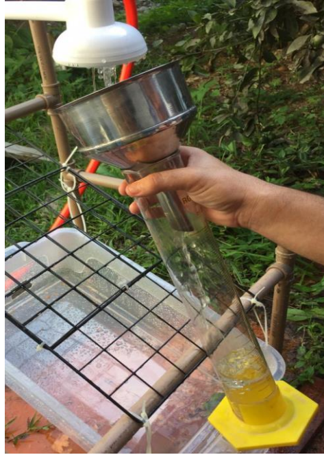
Figura 24: Medição de Vazão do Chuveiro Fonte: Autora, 2018
