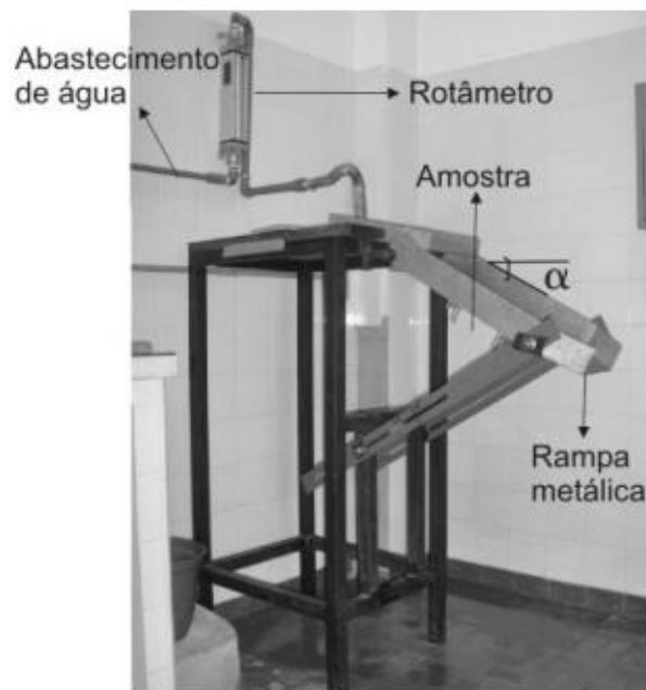
Figura 7: Equipamento de Inderbitzen Original Fonte: NAGEL, et. al. , 2015
