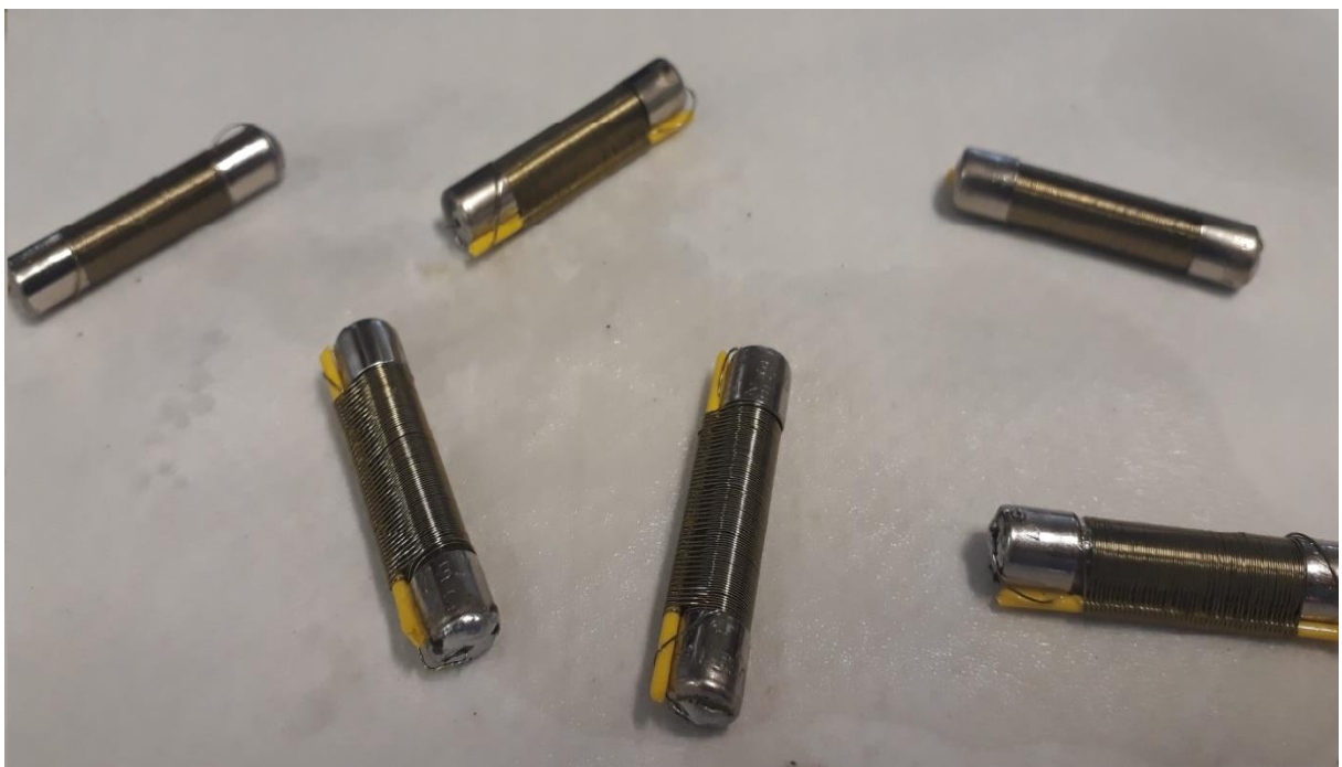
Figura 32 – Resistores de baixa tensão, feitos artesanalmente
