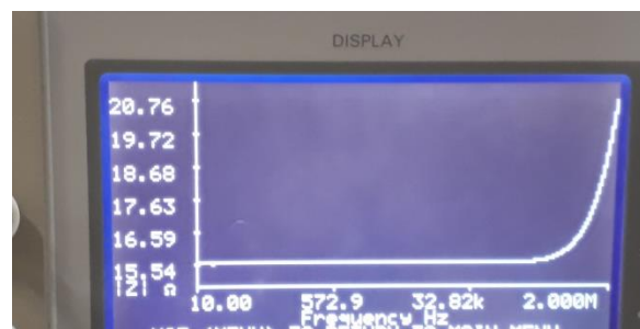
Figura 34 – Gráfico de comportamento da associação em paralelo dos seis resistores ( Z_{BT} ) de baixa tensão
