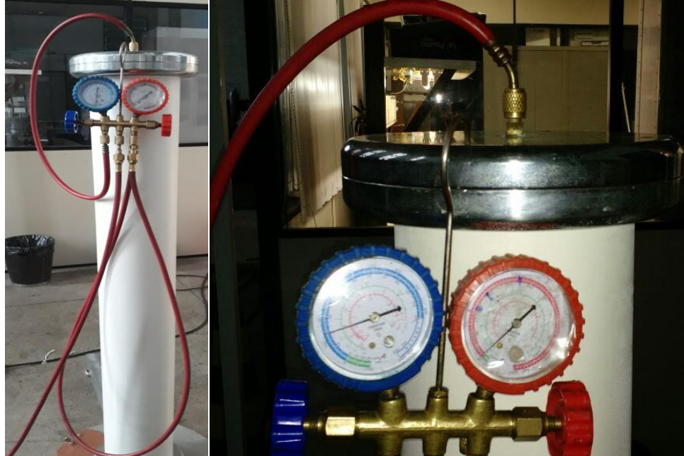
Figura 22 - Momento do vácuo e pressurização do divisor com gás nitrogênio
