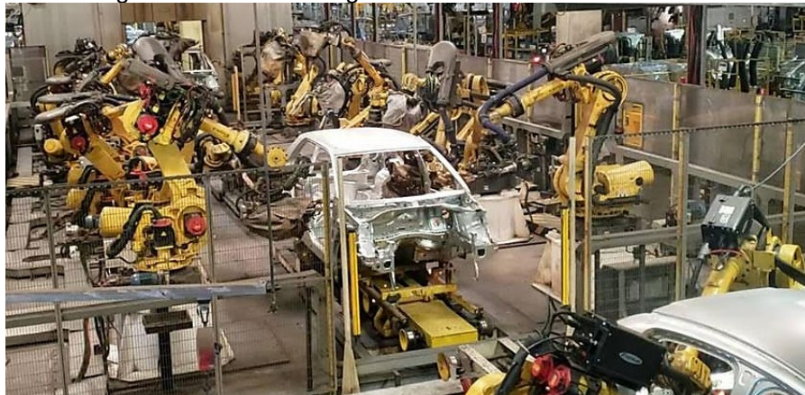
Figura 5: Área de soldagem automática da automobilística.
