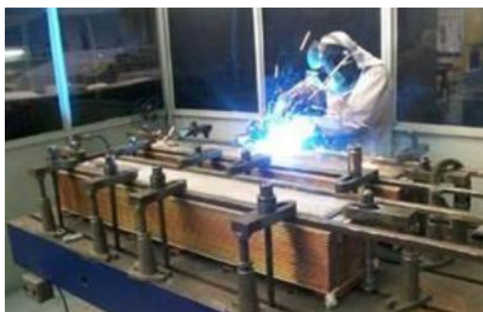
Figura 11 - Soldagem do quadro de pressão
