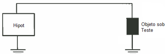
Figura 13 - Esquema para ensaio de tensão aplicada
