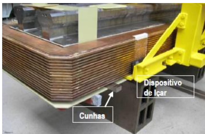
Figura 10 - Fixação do quadro isolante na bobina
