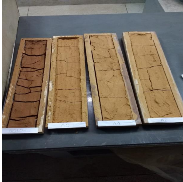
Figura 34 - Ensaio de Retração Linear dos Traços Solo, A0, A1 e A2 após secagem de 7 dias.
