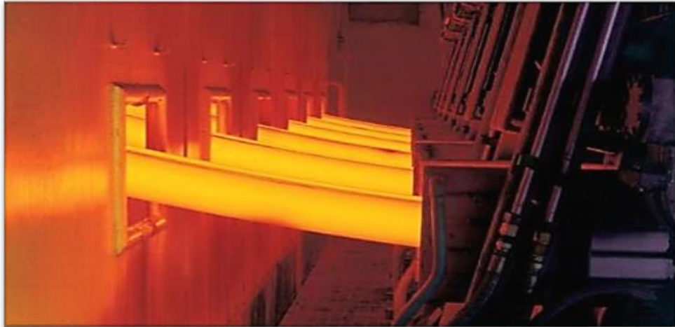
Figura 15: Final do desencurvamento da máquina de corte de placas
