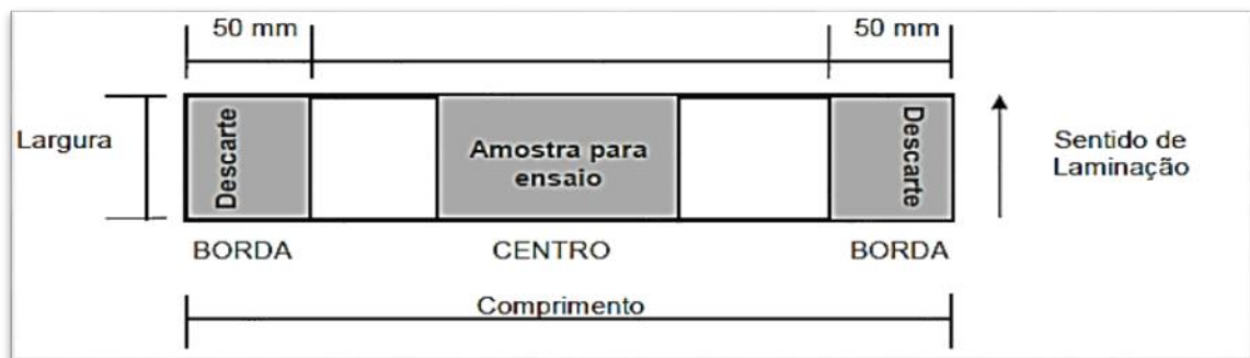
Figura 34: Desenho esquemático da preparação de um corpo de prova para um ensaio de tração
