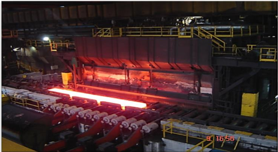
Figura 17: Placa após o reaquecimento no forno de placas Fonte: http://www.acobrasil.org.br/site2015/processo.html
