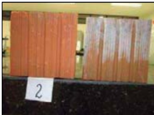
Figura 14 - Eflorescência no bloco cerâmico.
