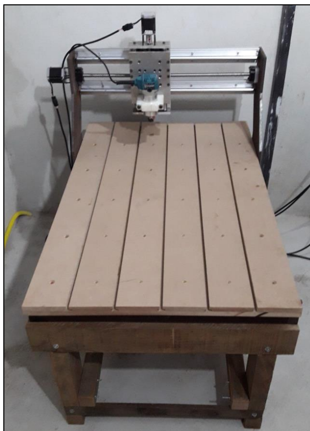
Figura 4.46 - Fresadora CNC Router montada e ajustada Fonte: Elaborada pelos autores.
