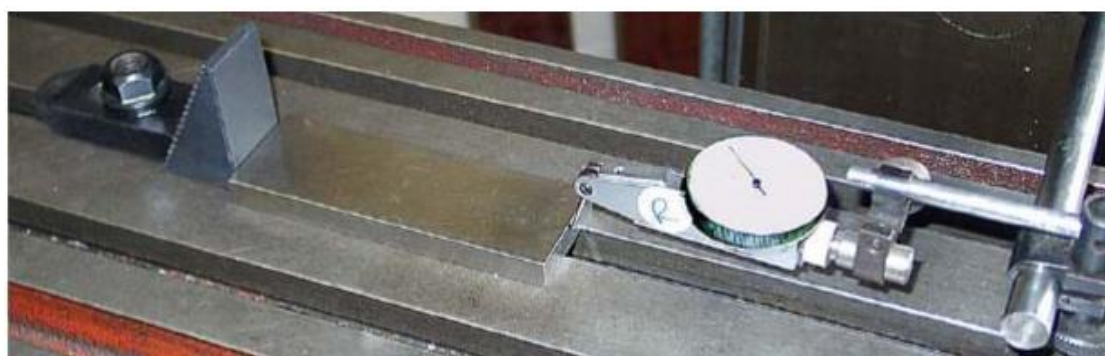
Figura 4.36 - Bloco de calibre em posição Fonte: Elaborada pelos autores.
