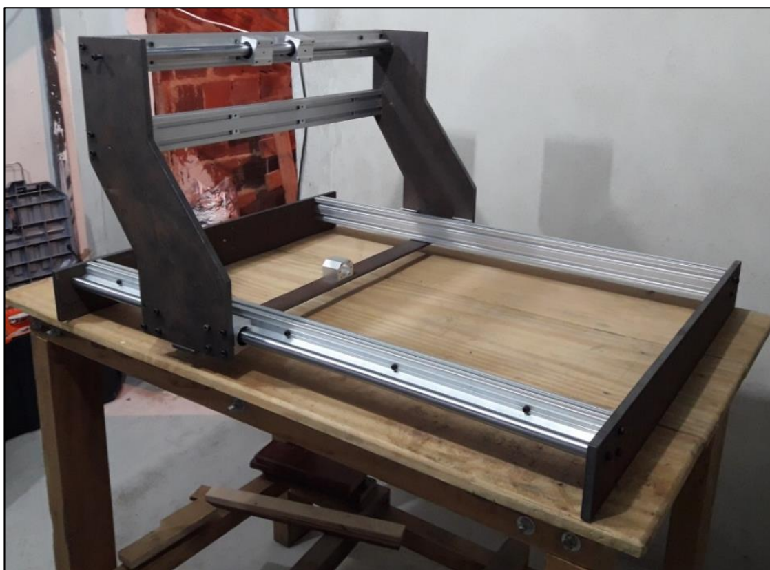
Figura 4.43 - Montagem da base da fresadora sobre a bancada sólida Fonte: Elaborada pelos autores.
