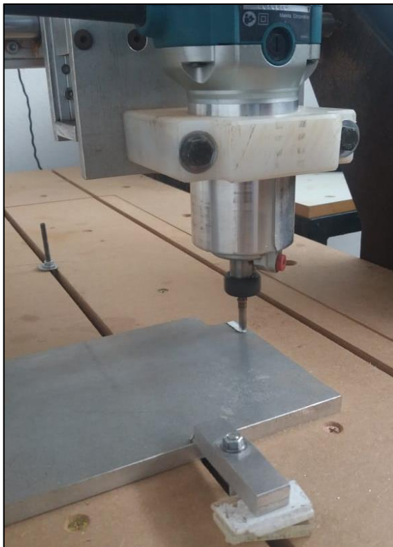
Figura 5.13 - Usinagem do alumínio Fonte: Elaborada pelos autores
