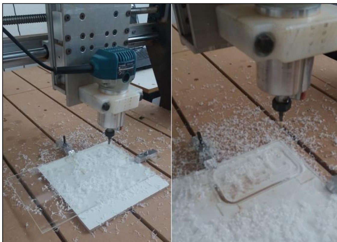
Figura 5.4 - Usinagem do acrílico. Fonte: Elaborada pelos autores.
