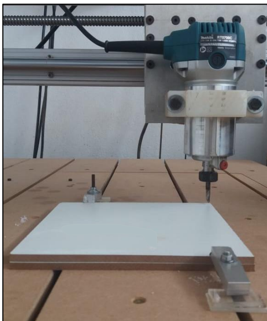
Figura 5.9 - Corpo de prova em MDF Fonte: Elaborada pelos autores
