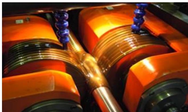
Figura 2.33 - Processo de laminação de fusos de esferas Fonte: www.kalatec.com.br . Acesso em 28/04/19.
