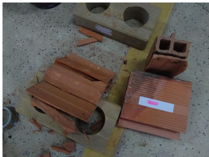
Figura 38: Argamassa de 40% com o tijolo rompido.
