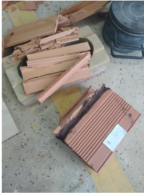
Figura 39: Argamassa de 50% com o tijolo rompido.
