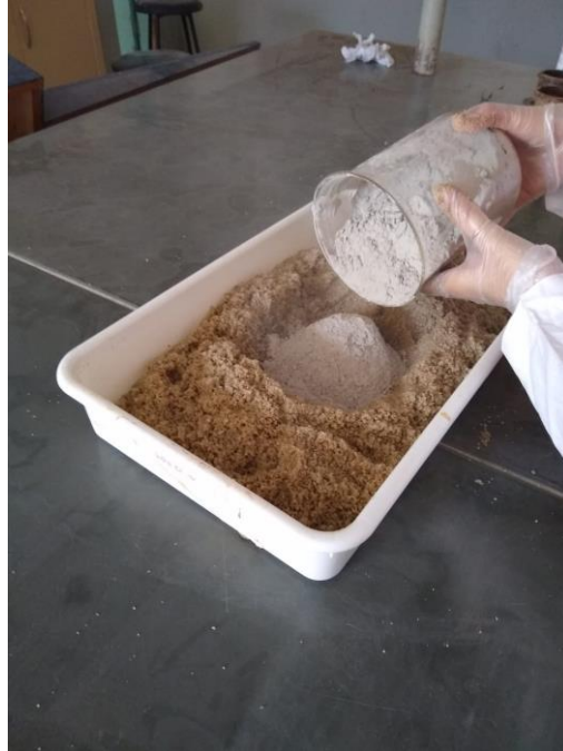
Figura 12: Mistura areia e cimento.
