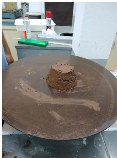
Figura 32: Argamassa polimérica antes dos 30 golpes.
