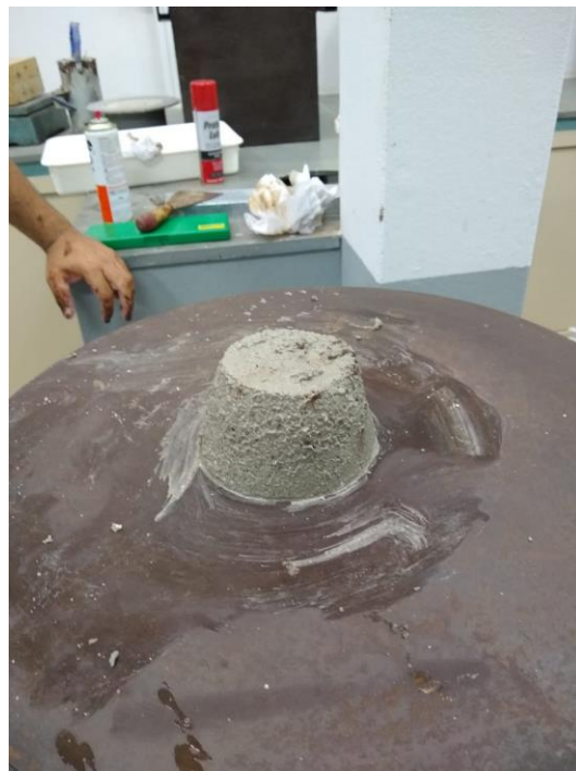
Figura 34: Argamassa convencional antes dos 30 golpes.
