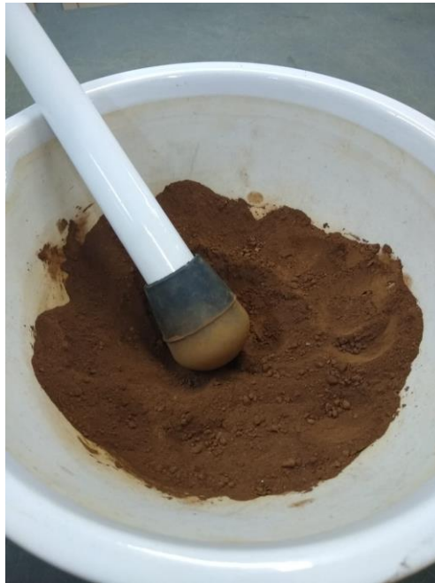
Figura 14: Destorroamento com almofariz e mão de grau.
