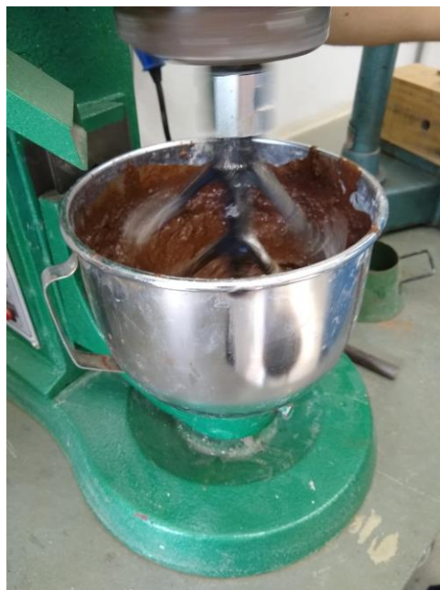
Figura 20: Preparo da argamassa polimérica.
