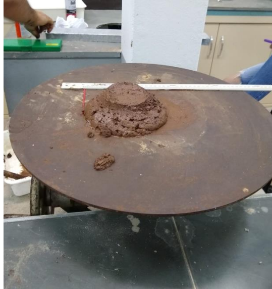
Figura 33: Argamassa polimérica após os 30 golpes.
