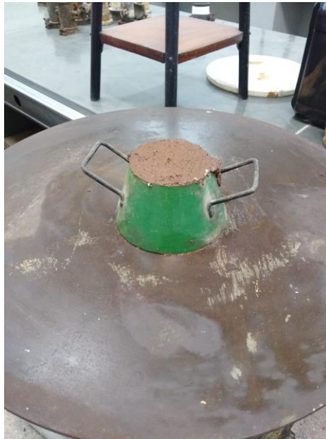
Figura 21: Teste de índice de consistência.
