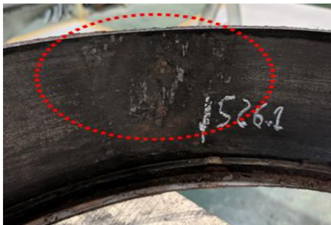
Figura 22 - Marcas de atrito no flange
