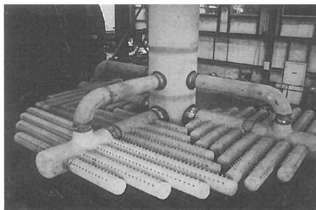
Figura 22: Estrutura “Pipe Grid”
