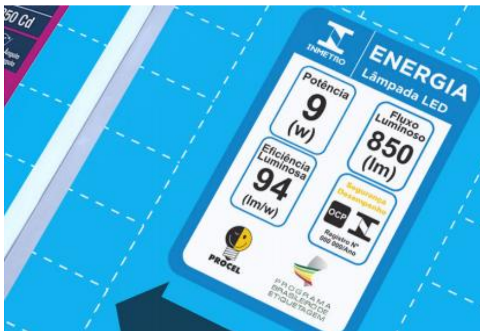
Figura 19 - Etiqueta de certificação do Inmetro para lâmpadas LED Fonte: Instituto Nacional de Metrologia, Qualidade e Tecnologia (INMETRO) (2015)
