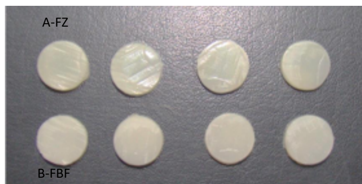
Figura 2 - Confeccção dos corpos de prova. (A) Resina composta Filtek Z350XT e (B) Resina composta Filtek Bulk Fill
