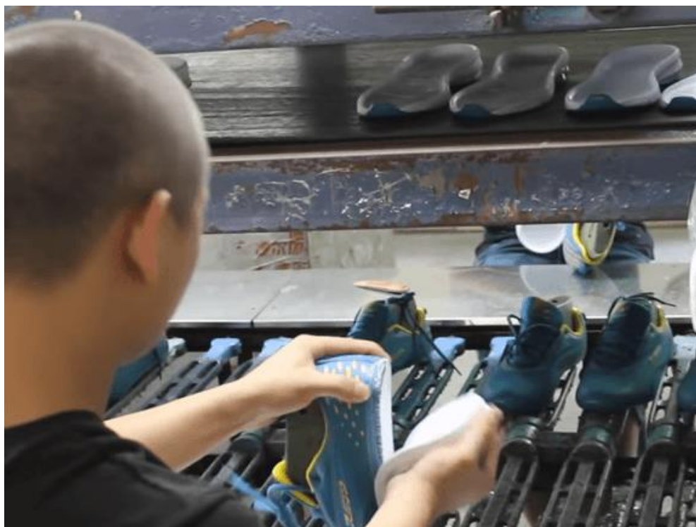
Figura 31: adicionando a sola ao cabedal com meia estrobel
