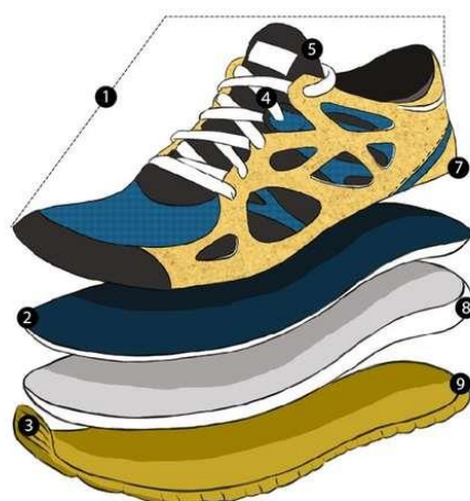
Figura 25: As diferentes partes de um tênis
