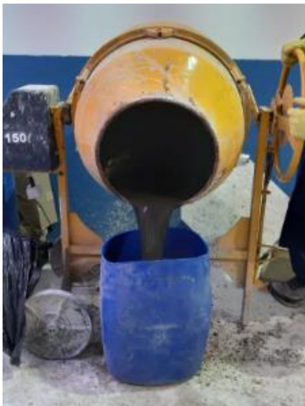
Figura 6 - Lavagem da areia em betoneira. Fonte: Autores.
