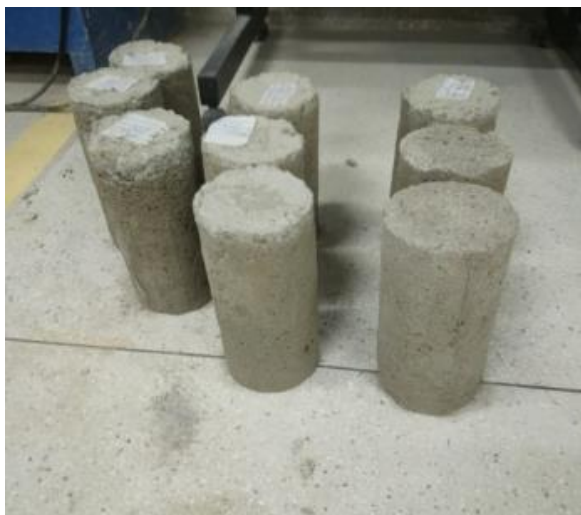
Figura 13- Corpos de Prova com cura de 14 dias. Fonte: Autores.
