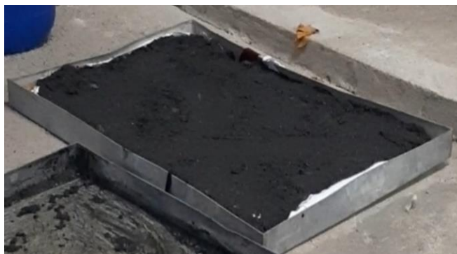
Figura 7 - Areia disposta em fôrmas forradas com tecido. Fonte: Autores.
