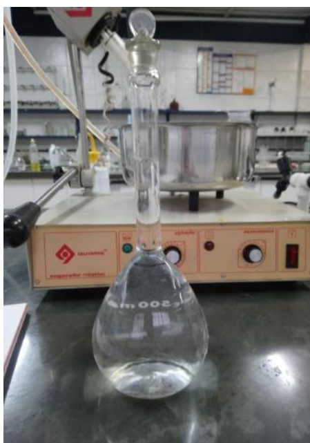
Figura 8 - Preparação da solução de Hidróxido de sódio a 3%. Fonte: Autores.
