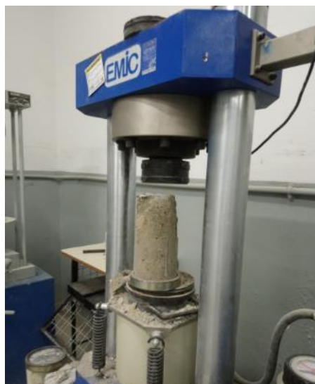
Figura 14 - Ensaio de Compressão axial do corpo de prova. Fonte: Autores.
