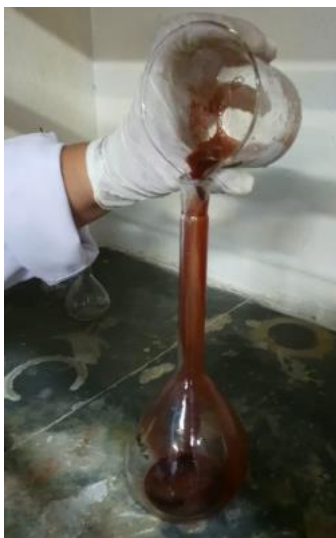
Figura 9 - Preparação da solução de Ácido tânico a 2%. Fonte: Autores.
