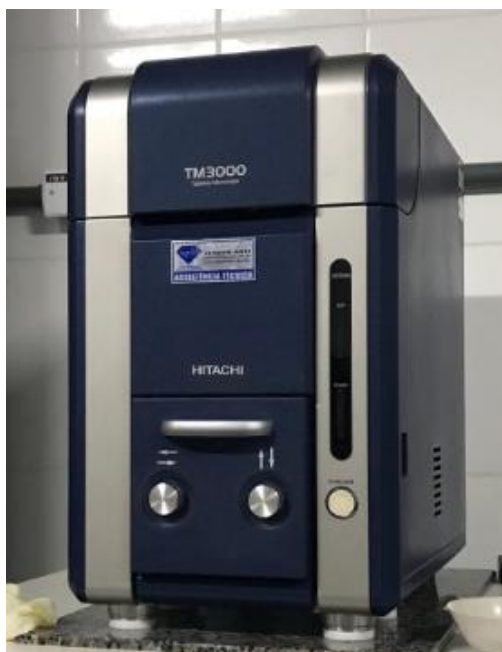
Figura 12 - Aparelho utilizado para análise do MEV. Fonte: Autores.
