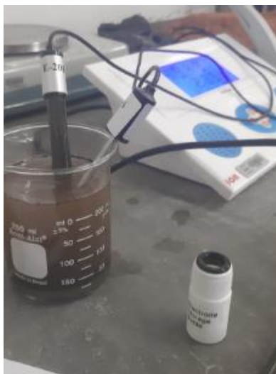
Figura 11 - Análise do pH através da submersão de eletrodo combinado. Fonte: Autores.
