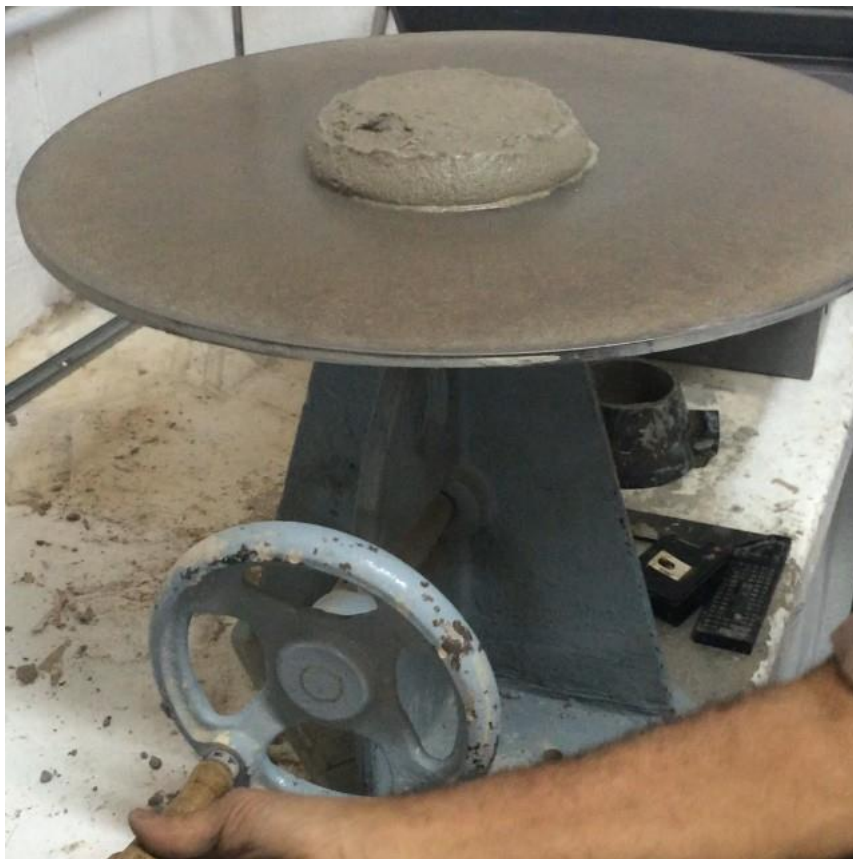
Figura 12 - Mesa para Ensaio de índice de Consistência
