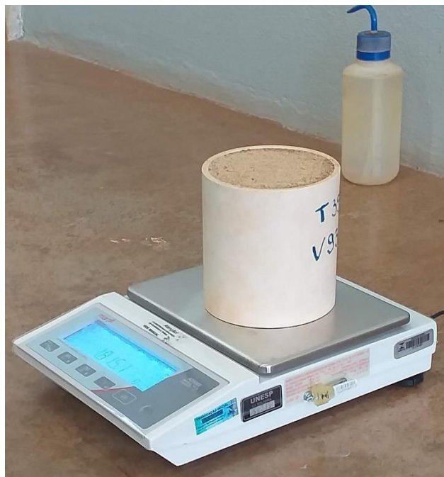
Figura 11 - Pesagem do molde de PVC com a argamassa
