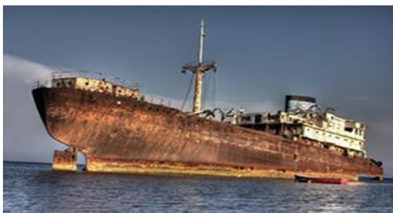
Figura 14: Corrosão em navio de carga
