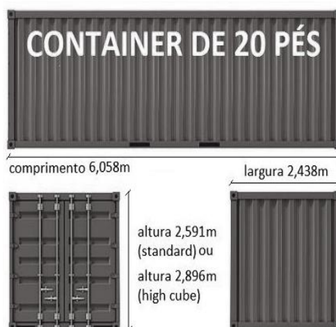
Figura 3: Dimensões do Container de 20 pés.
