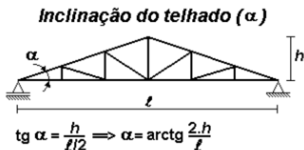
Figura 27: Inclinação do telhado.
