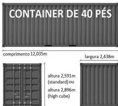
Figura 4: Dimensões do Container de 40 pés.
