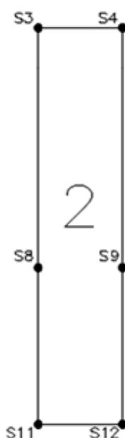
Figura 30: Distribuição das sapatas para um container.
