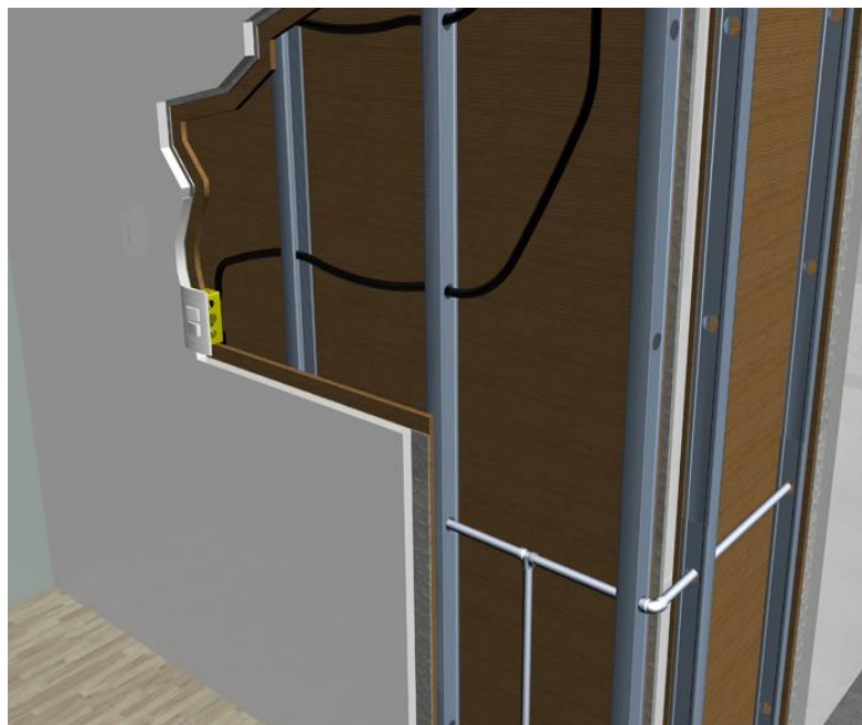
Figura 60: Modelo esquemático dos elementos internos constituintes do revestimento.
