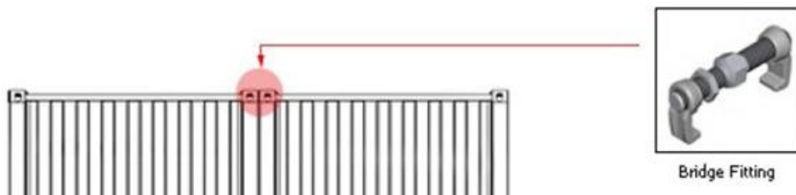
Figura 39: União no topo dos containers
