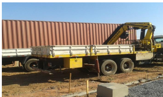
Figura 34: Posicionamento do caminhão munck ao lado do terreno
