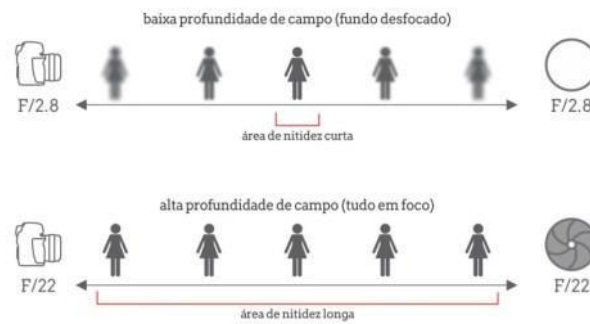
Figura 44 - Explicação de como funciona a profundidade de campo
