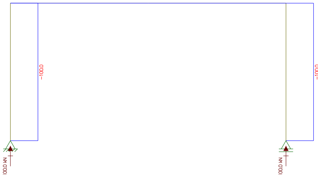
Gráfico 7 - Diagrama de força normal para estrutura engastada/apoiada Fonte – Elaborado pelos autores.
