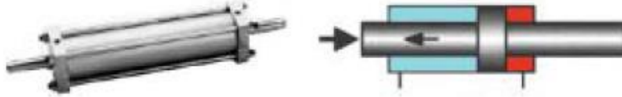
Figura 19: Cilindro de haste dupla
