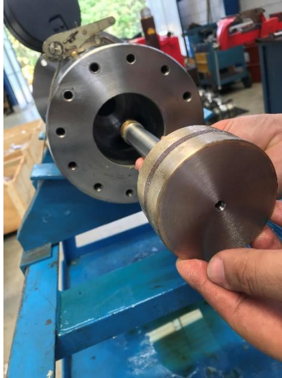
Figura 93: Montagem da haste êmbolo na camisa
