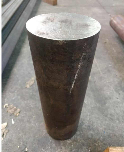
Figura 76: Tarugo 4" de aço 1045
