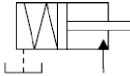
Figura 16: Cilindro hidráulico de ação simples e haste simples, com retorno por mola
