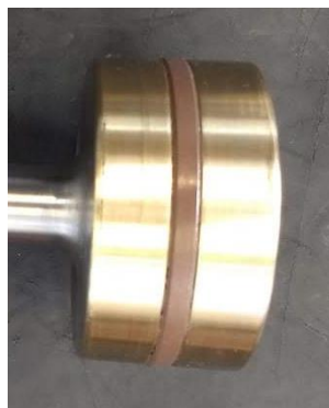
Figura 92: Montagem das vedações
