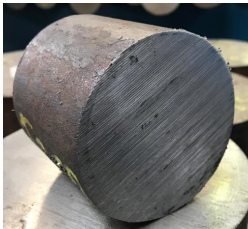
Figura 82: Tarugo 4" de aço 1045
